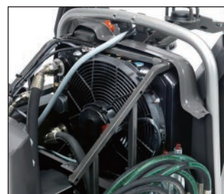
自动电动风扇提供最大冷却能力
