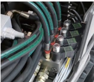
插头 - 连接 / 分离时无需使用工具
