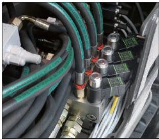
插头 - 连接 / 分离时无需使用工具
