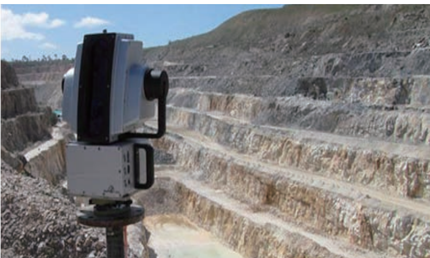
露天边坡位移监测
